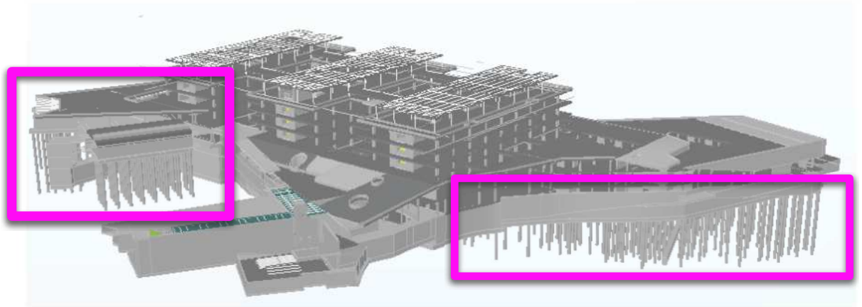
Palificazioni e Tiranti su Corso Mentana vincolata
